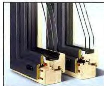
La fenêtre mixte Rockframe de Rockwool GmbH associée dormant et ouvrant bois à une protection extérieure en laine de roche pour améliorer la performance thermique. Rockwool fournit ces profilés en laine de roche dans l'ensemble des teintes du nuancier RAL et annonce une durée de vie de 50 ans.
