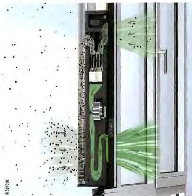
La centrale de purification et de soufflage d'air frais automatique VentoLife est intégrée aux menuiseries.
