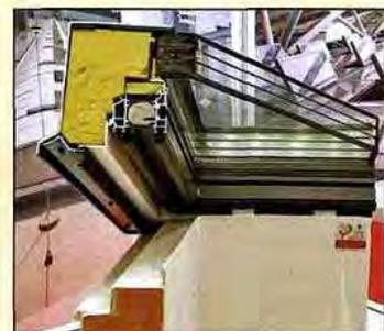
Lamilux a certifié trois modèles de lanterneaux au standard Passivhaus. Ils font appel à du quadruple vitrage avec menuiseries aluminium, complétés par une injection de mousse polyuréthane et plusieurs rupteurs de ponts thermiques.
