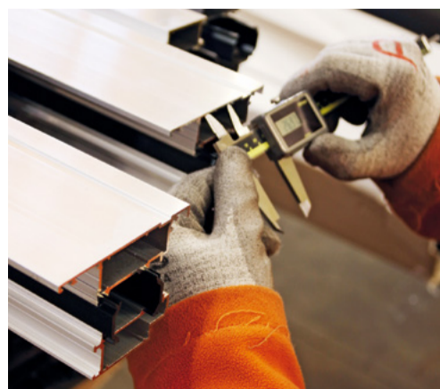
Contrôle des côtes géométriques d'extrusion.
