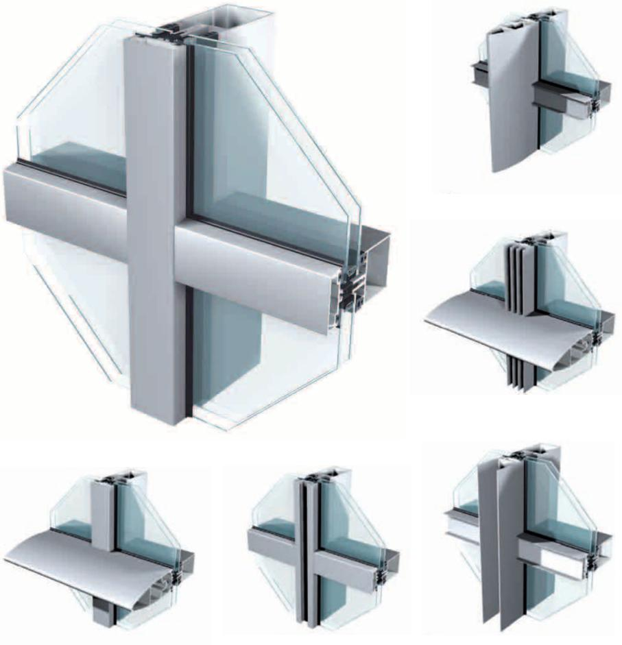
Elegance 52 ST est un système de profilés en aluminium pour mur-rideau standard avec capot serreur, à isolation thermique. Il offre une infinité de possibilités grâce à une combinaison de différents designs de coiffes et de meneaux et un large éventail de couleurs.
